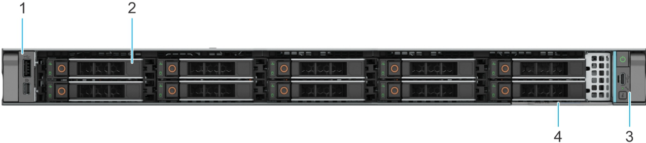
그림 5. 10개의 2.5" 드라이브 시스템의 전면 모습(후면 I/O 포함)
