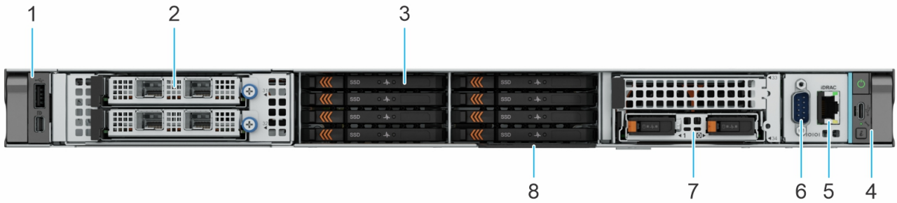
그림 2 . 8개의 EDSFF E3.S 드라이브 시스템의 전면 모습(전면 I/O 포함)
