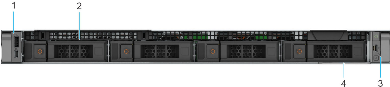
그림 6. 후면 I/O가 있는 4개의 3.5인치 드라이브 시스템의 전면
